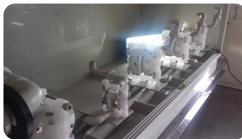
Réalisation de skid nucléaire sur mesure – PVDF – Soudage infrarouge et polyfusion
