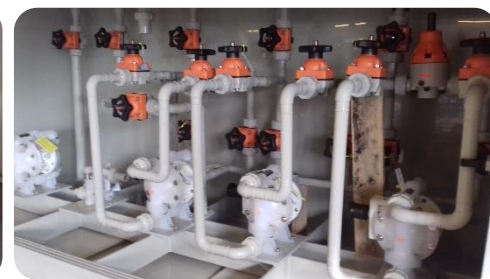
Réalisation de skid nucléaire sur mesure – PVDF – Soudage infrarouge et polyfusion
